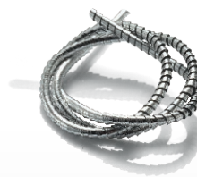
vorher Spanbildung mit herkömmlicher Bearbeitung
