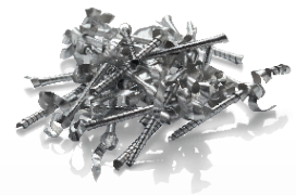
nachher Spanbildung mit High-Frequency-Turning
