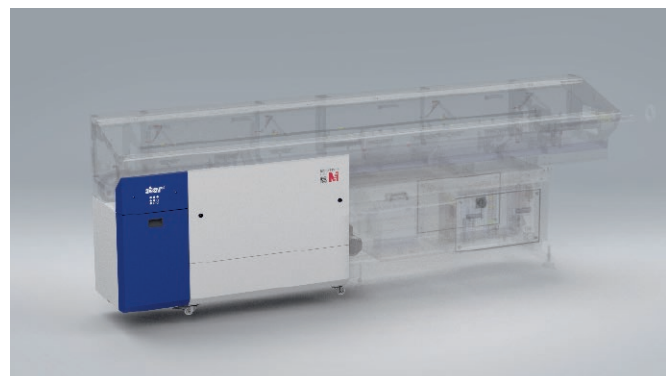
HOCHDRUCKAGGREGAT IM GRUNDRAHMEN INTEGRIERT
