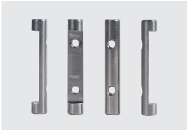
Achse: komplett gefertigt mit fräsen, querbohren und Gewinde M4 Laufzeit auf SR-20R II: 1 Minute, 56 Sekunden
