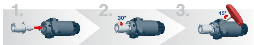
Werkzeugwechsel mit wenigen Handgriffen in Sekundenschnelle
