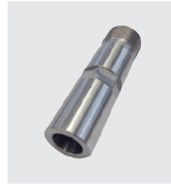
Stellhülse lang: Material C45, Teillänge 75 mm, Bohrungsdurchmesser 14,2 mm Laufzeit auf SV-38R: 1 Minute, 56 Sekunden
