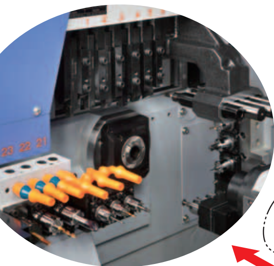
Arbeitsraum der SR-20J/JN. Insgesamt stehen bis zu 30 Werkzeuge zur Verfügung – davon 14 Werkzeuge angetrieben.
